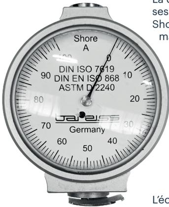
La dureté d'un rouleau indique la résistance de la surface en caoutchouc à l'indentation, ce qui impacte ses performances dans différentes applications. Elle est mesurée avec l'échelle de dureté Shore, l'échelle Shore A étant la plus courante pour les matériaux en caoutchouc. Un chiffre Shore A plus élevé indique un matériau plus dur.
